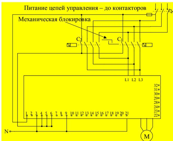
Управление пуском осуществляется от дополнительных нормально открытых контактов сетевых контакторов  $C_1$  и  $C_2$ . Замыкание любого контактора приведет к включению силового питания и подаче сигнала пуска на RVS-DN.
